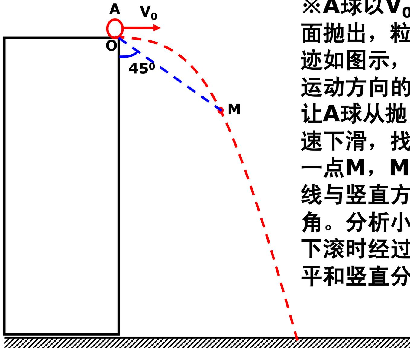
※**A球以 $V_0$ 速度从台面抛出，粒子运动轨迹如图所示，做一个沿运动方向的光滑曲面，让A球从抛出点无初速下滑，找轨道上的一点M，M与O点连线与竖直方向成 $45^\circ$ 角。分析小球无初速下滚时经过M点的水平和竖直分速度。**
