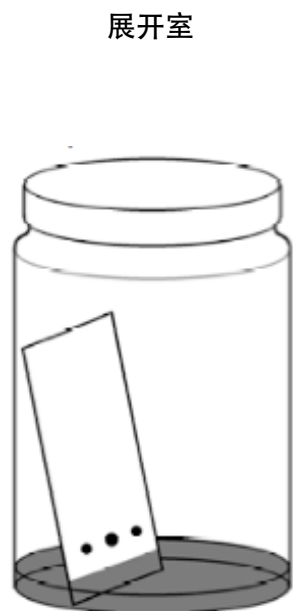
图39.1 带盖广口瓶中的TLC板
